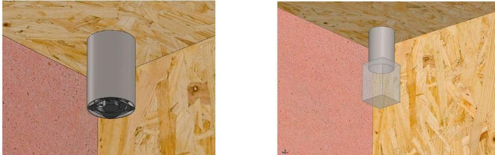
Es aconsejable proteger el ventilador con una mosquitera colocada entre el local y el ventilador. Se debe proporcionar una rejilla lo suficientemente grande como para no ralentizar el flujo de aire.
